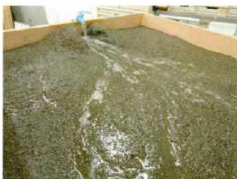
写真⑤ 流路を変化させる水流により形成された堆積性の扇状地
